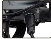
An den Controller angeschlossener Akku
