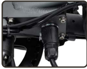
Batterie connectée au contrôleur
